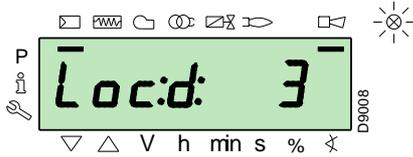
Para desbloquear presionar la tecla "i/reset" durante 1 seg: en el display aparece "rESEt". Al soltar la tecla desaparecerá la señal de bloqueo y se apagará el indicador luminoso rojo. La caja de control está desbloqueada.
