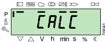
La caja de control indicará automáticamente los mismos valores configurados en los puntos "P0" y "P1" en los puntos de "P2" a "P8".
