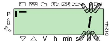
confirmar presionando la tecla "i/reset" para activar el proceso de **restore**.
