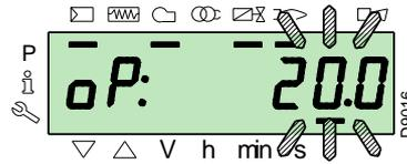
Mantener presionada la tecla "F" y, con las teclas "+" o "-", aumentar o disminuir el porcentaje de carga.
