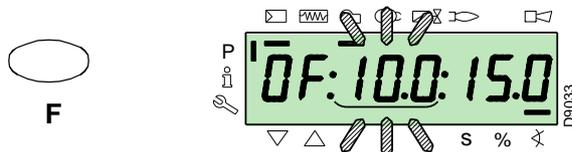
Para el servomotor del aire, mantener presionado la tecla “A” (la posición en grados parpadea) y presionar las teclas “+” o “-” para aumentar o disminuir el valor.
