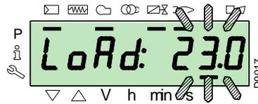
Para salir del modo manual presionar al mismo tiempo las teclas "+" y "-" (ESC) durante 3 segundos: el quemador funcionará en modo automático y la potencia dependerá del termostato/presostato de regulación (TR).
