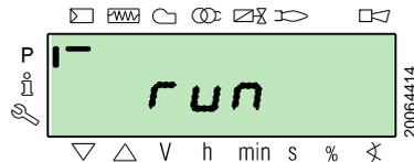
Confirmar presionando la tecla "i/reset". El quemador se pone en funcionamiento.
