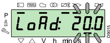
Soltando el pulsador "F" aparece la visualización estándar con el porcentaje de carga actual parpadeando: esto significa que el quemador está funcionando en manual (se excluye cualquier regulación externa, solamente están activos los dispositivos de seguridad).
