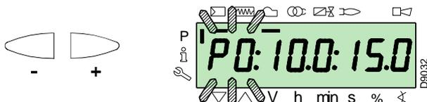
Para el servomotor del combustible, mantener presionada la tecla “F” (la posición en grados parpadea) y presionar las teclas “+” o “-” para aumentar o disminuir el valor.
