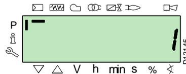
Después de aproximadamente 5 segundos (dependiendo de la duración del programa), en la pantalla se visualiza el valor **0** que indica que el proceso de backup ha finalizado correctamente.
