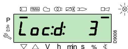
El display visualiza alternadamente un código y una diagnosis de error, que no conduce al sistema a seguridad.
