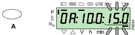
Para regular la velocidad del inverter (expresada en % es decir 50 Hz = 100 %), mantener presionadas simultáneamente las teclas “F” y “A” la posición en porcentaje parpadea y presionar las teclas “+” o “-” para incrementar o disminuir el valor.
