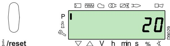
Presionar la tecla "+" y aumentar el valor a 25 segundos (parpadeando). Presionar la tecla "i/reset" para confirmar y memorizar.
