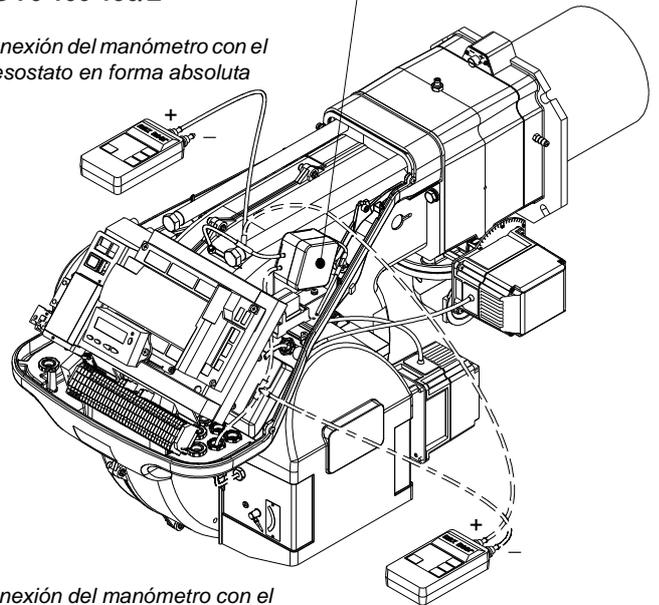
Conexión del manómetro con el presostato en forma diferencial
