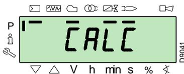
La caja de control calculará automáticamente los puntos de "P8" a "P2", distribuyéndolos en una recta. Los mismos son teóricos y se deben verificar.
